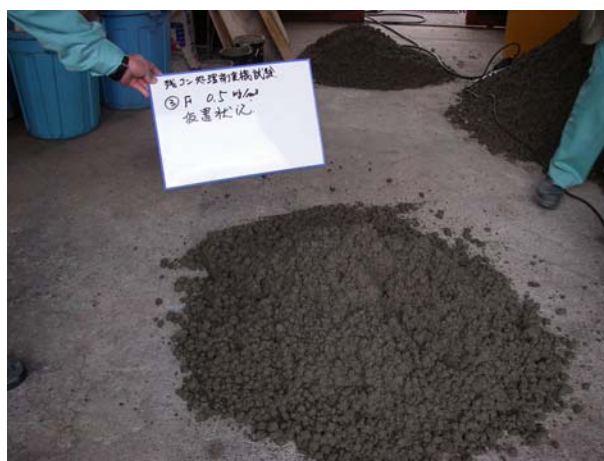
写真-2 排出直後の団粒化状況 (レスクリート 0.5 kg/m 3 )
