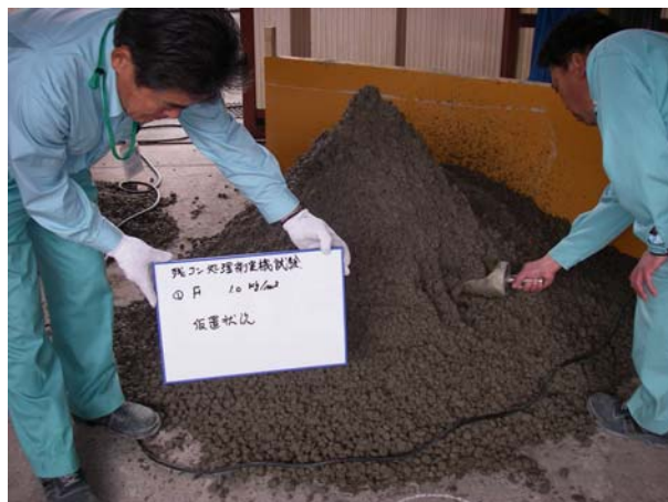
写真-1 排出直後の団粒化状況 (レスクリート 1.0kg/m 3 )
